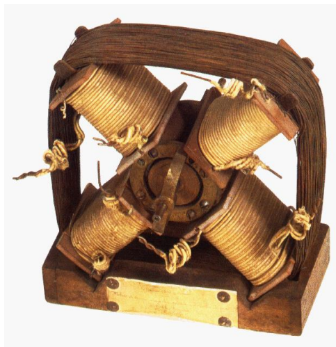
Рис.5 Двухфазный асинхронный двигатель Феррариса 1885 года.
