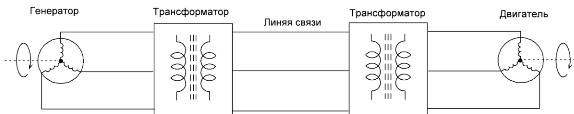
Рис.1 Схема трёхфазной электрификации.
