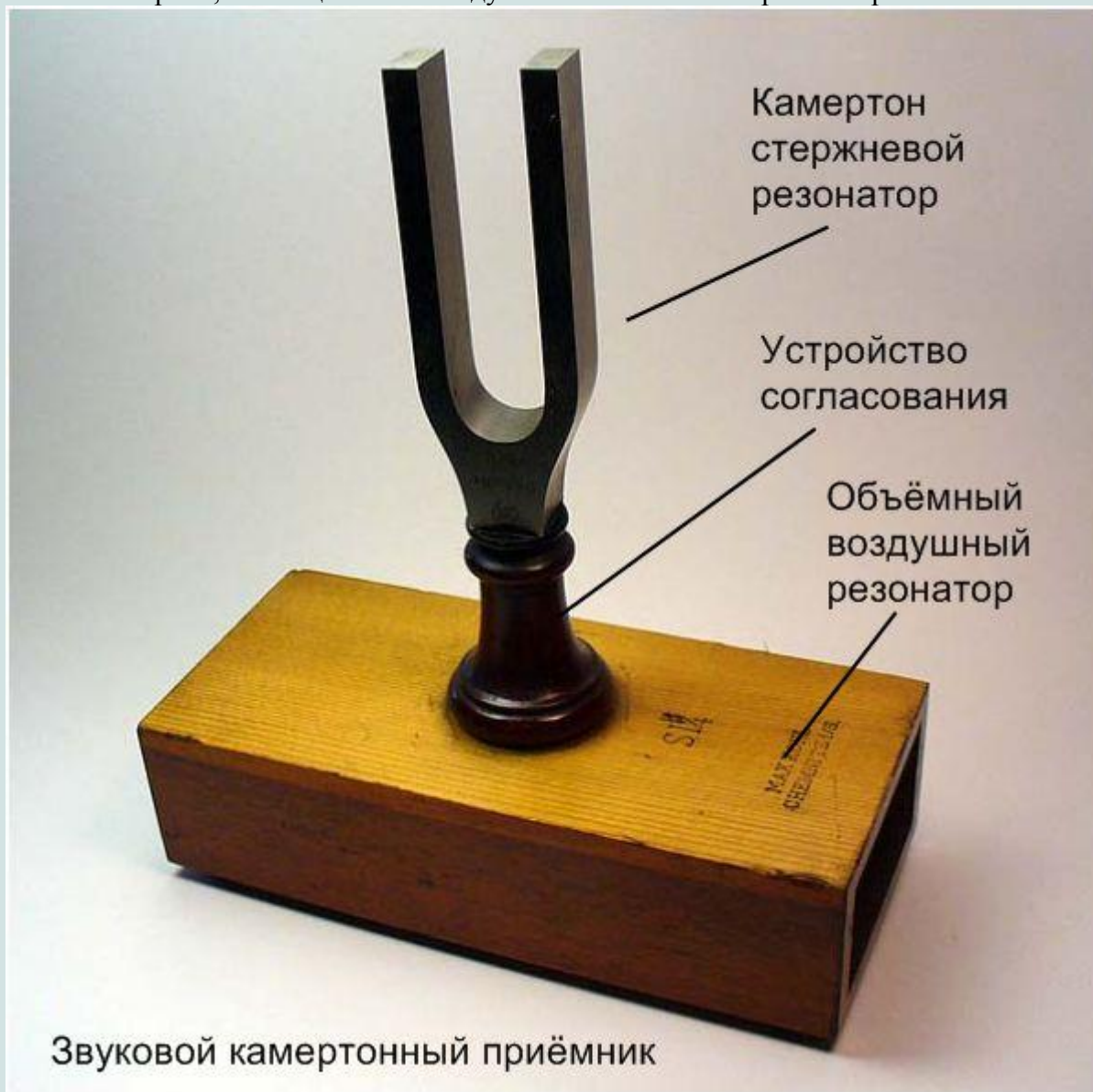
Рис.24 Камертон, совмещённый с воздушным 1/4 волновым резонатором.
